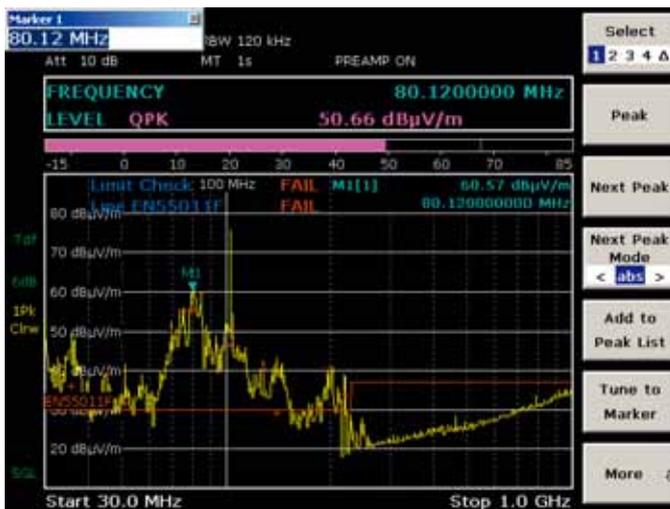
测量曲线的设置菜单。最多可以同时用6个不同的检波器进行扫描，并同时显示。ESL会自动标记出那些临界的频率点用于终测。
