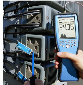
选配的近场探头用于测试电磁场
