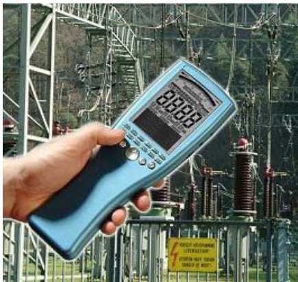
高压电力系统电磁辐射检测
