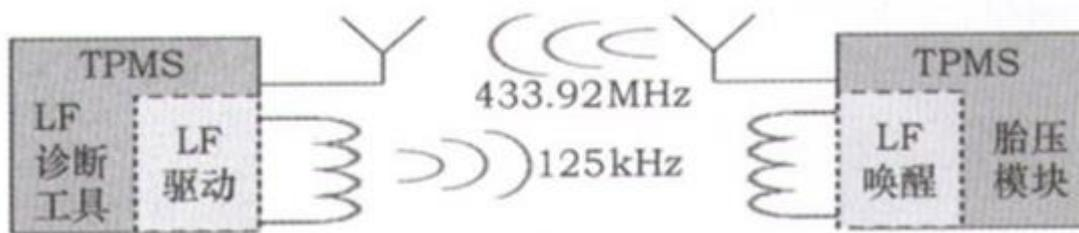
LF 低频信号经过编码和调制后发射,胎压模块侦测到 LF 信号时,将从休眠唤醒并接收低频信号,胎压模块再将传感器数据通过 433.92MHz 的射频信号发射给控制模块。
