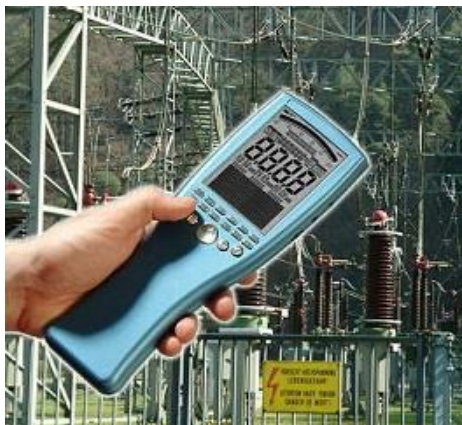
高压电力系统电磁场强度检测
