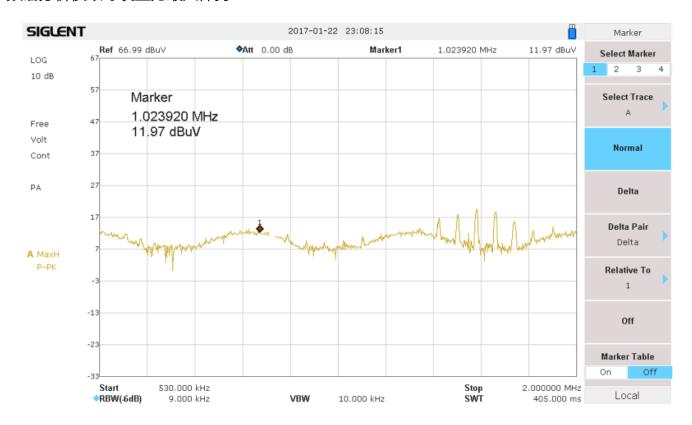
尽管存在AM广播信号中的一些峰值,但在测得的频谱中可见的"峰值"与屏蔽暗室内的测量图很好地相关。 与在屏蔽暗室中测得的幅度相比,在TEM单元中测得的幅度大约低20 dBμV。
