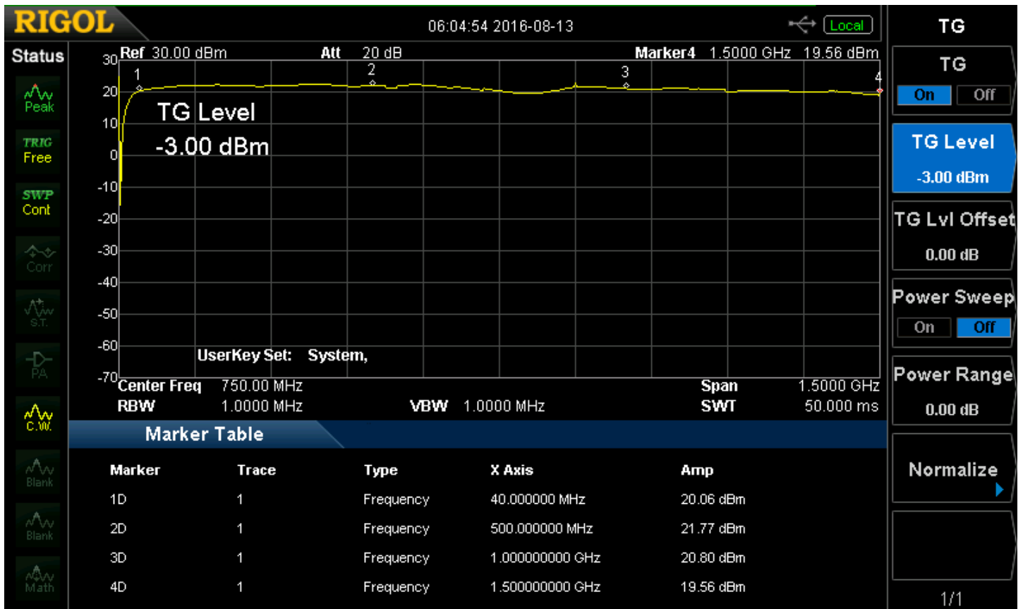
TBMDA1, CW的输出功率, 由DSA815跟踪源-3dBm驱动
