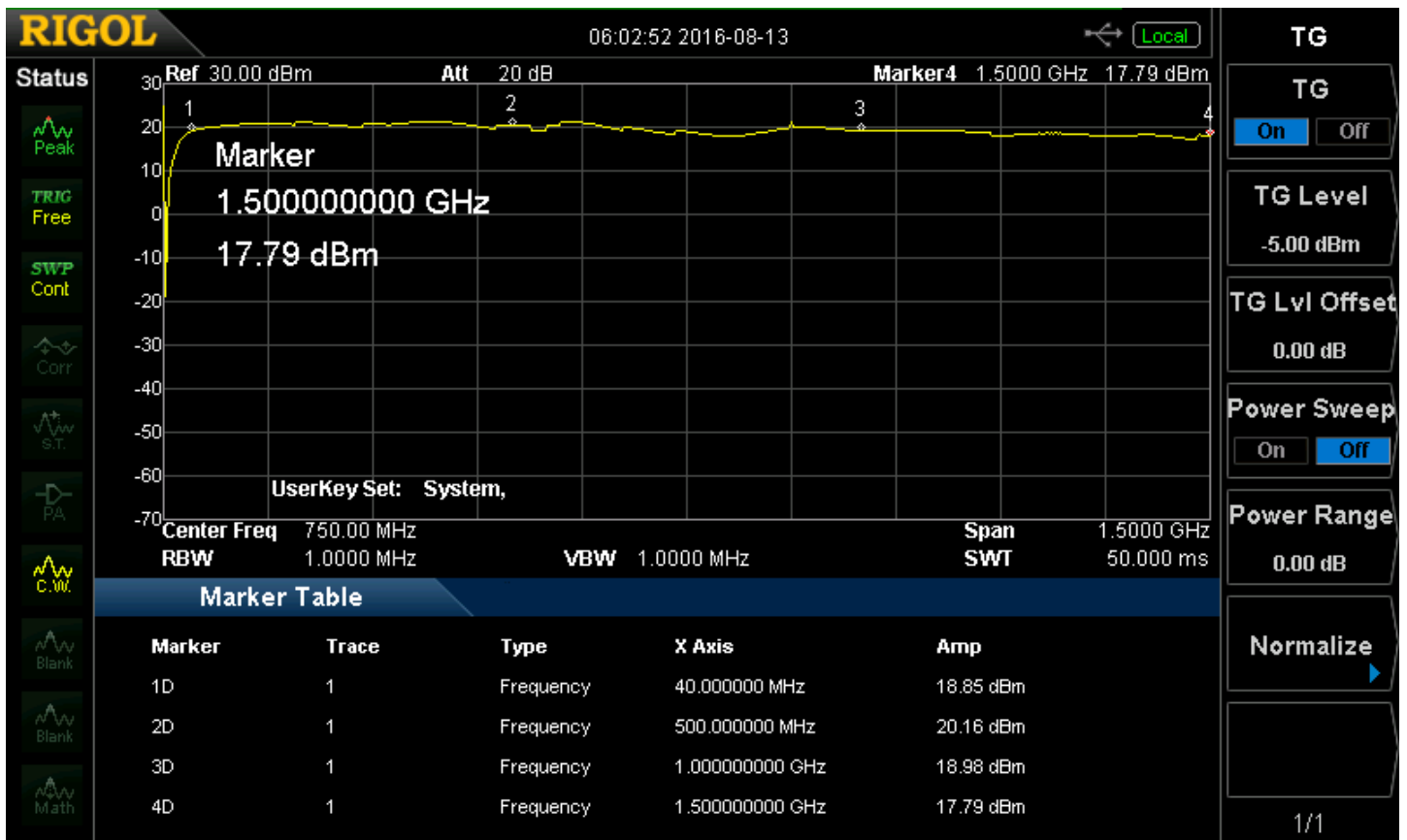
TBMDA1, CW的输出功率, 由DSA815跟踪源-5dBm驱动
