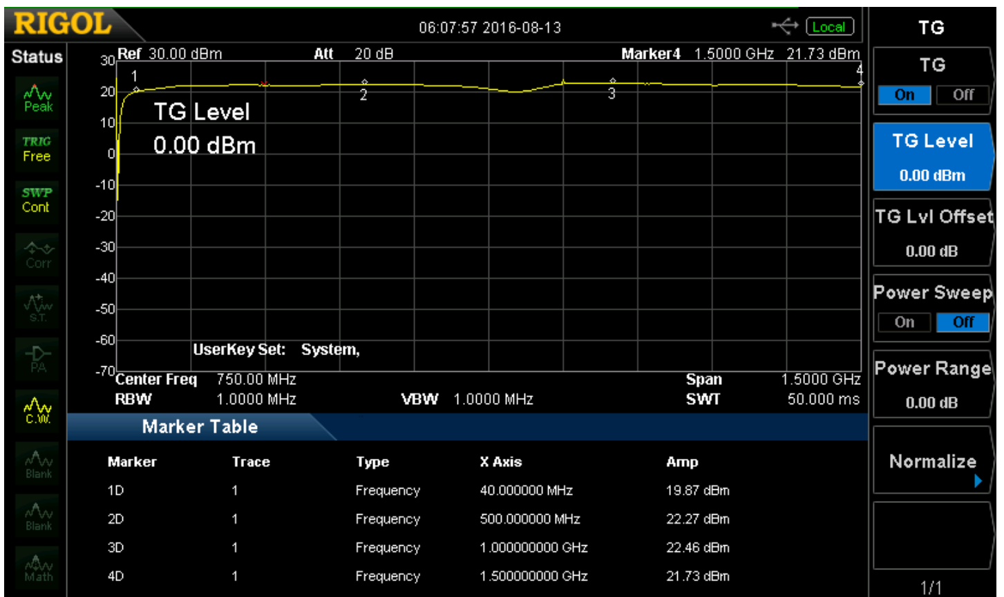
TBMDA1, CW的输出功率, 由DSA815跟踪源0dBm驱动
