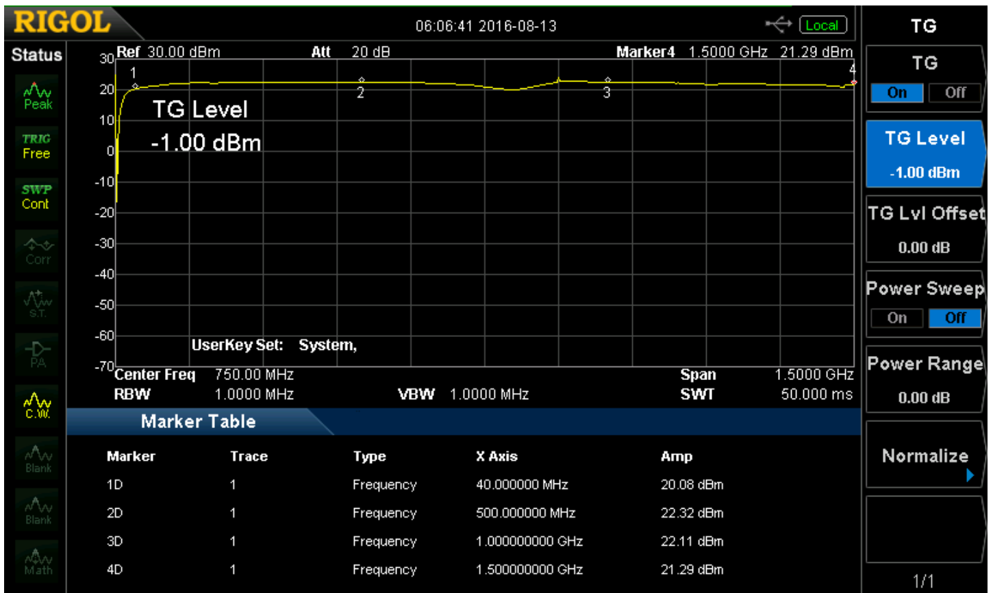
TBMDA1, CW的输出功率, 由DSA815跟踪源-1dBm驱动
