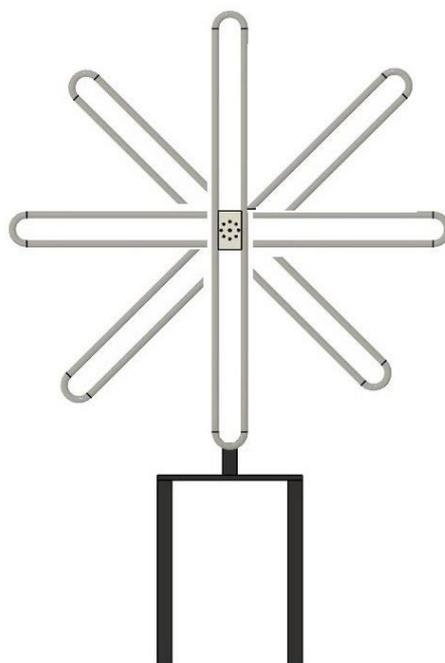
在每个校准偶极子的八个位置，测得的验证因子以 dBΩ 为单位表示为  $20\log(VGO/I1)$ ，其中 VGO 为射频发生器输出的开路电压，I1 为测得的环形天线电流。
