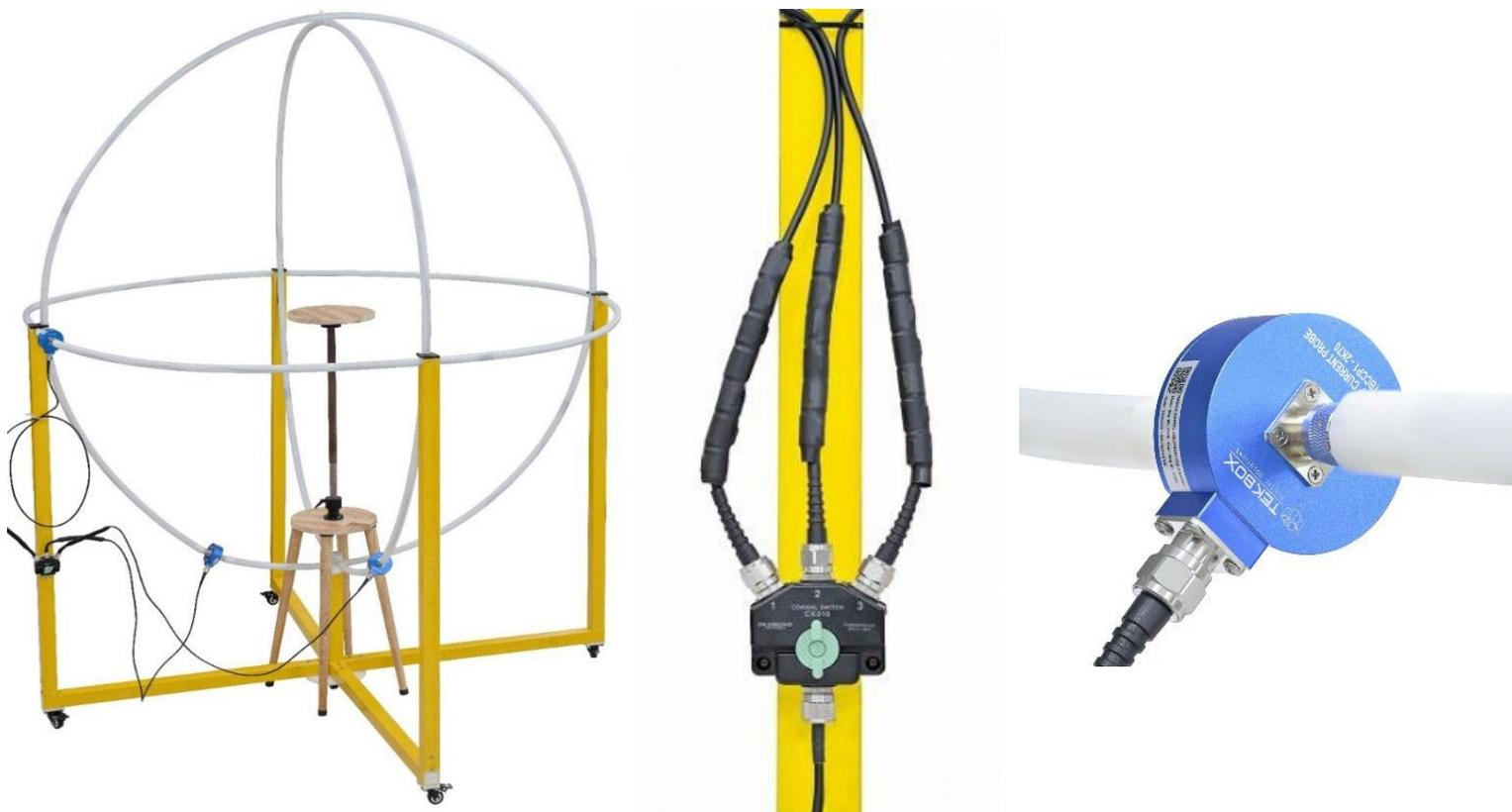
TBLLA-2M 由三个直径为 2 米、相互垂直的环形天线组成，分别位于三个正交平面 (X/Y/Z) 上，安装于轻质空心 WPC 框架上，整体高度为 2.5 米。环形天线的最低点距地面 0.5 米。每个环形天线单元接收垂直于其所在平面的磁场辐射，并在连接至环形天线的射频传感器输出端口处生成与 H 场辐射强度成正比的电压信号。
